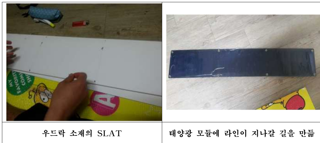
<그림 3.1 블라인드 SLAT 제작>
