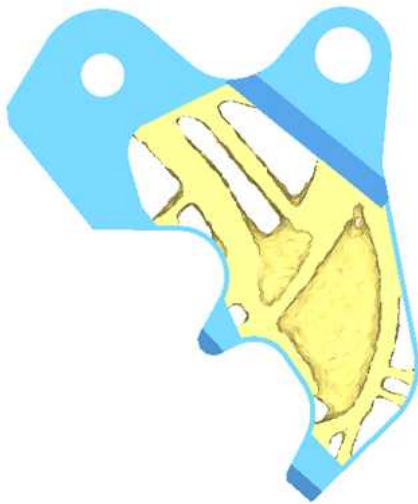
그림 3-3-1 크러셔 커터 최적화 설계
